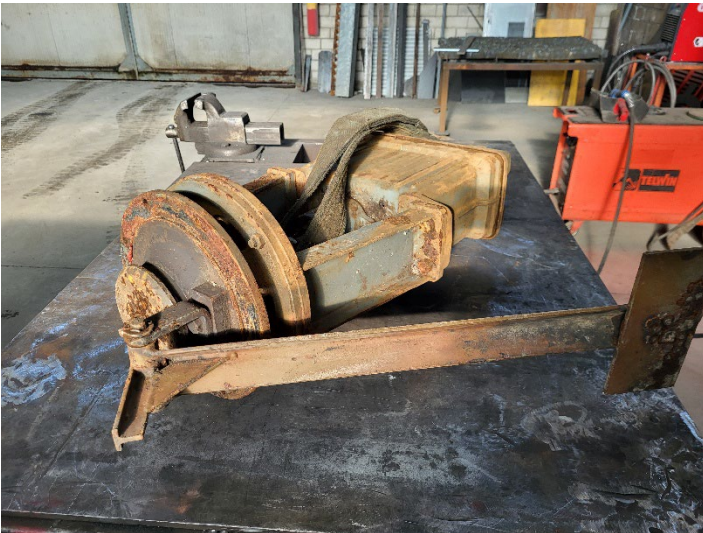
Idrovora Valgrande - revisione valvola di disadescamento.
