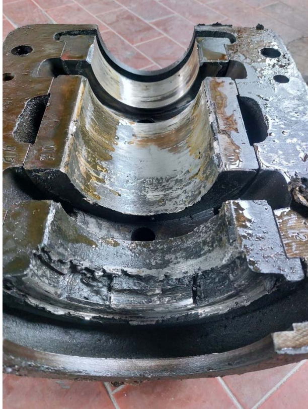
Ripristino bronzine in metal bianco e allineamento girante idrovora Grompa
