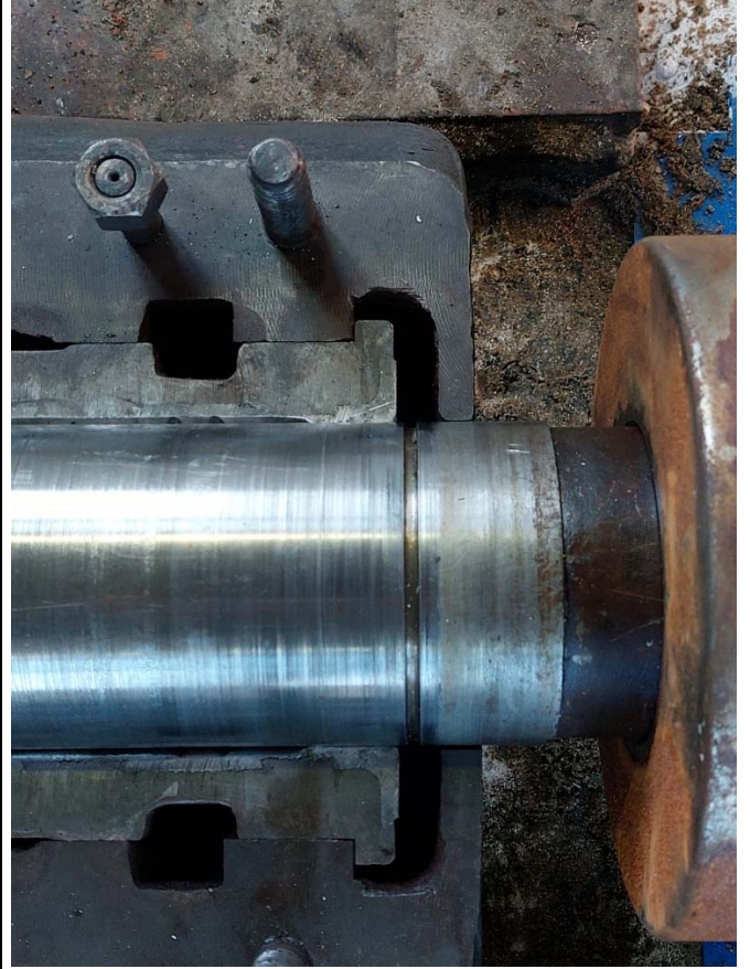
Ripristino bronzine in metal bianco idrovora Barbegara
